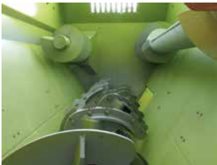
Příklad konstrukce horizontálního šnekového míchacího systému
