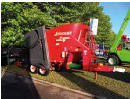
Vertikální KMV střední výkonové kategorie s integrovaným nakládacím zařízením
