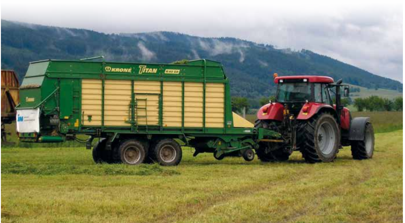
Klasický senážní vůz s řezacím ústrojím doplněný dávkovacími válci a příčným dopravníkem
