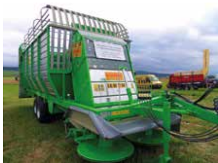
Speciální sběrací vůz s integrovaným bubnovým žacím strojem pro přípravu zeleného krmení
