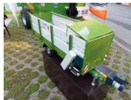
Funkční maketa základacího krmného vozu klasické konstrukce
