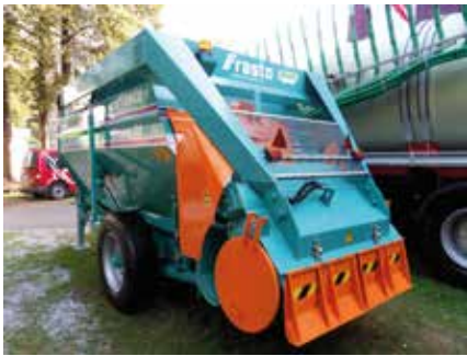
Tažené horizontální KMV se zpravidla dodávají s frézovacím zařízením
