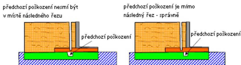
Obr. 34 - umístění kmene v případě předchozího poškození desky
